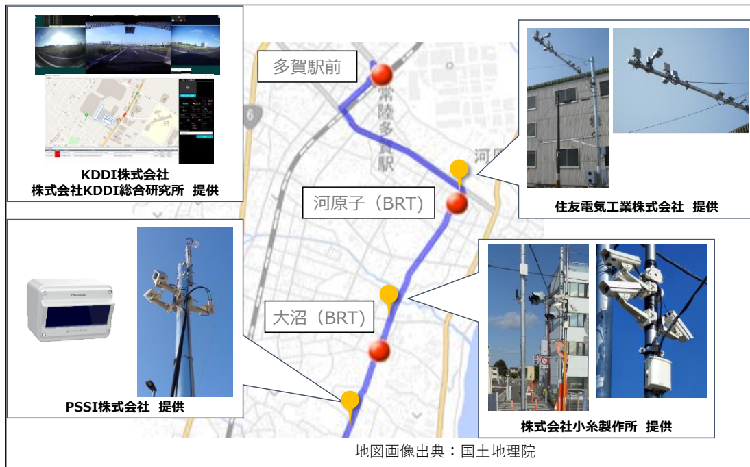
図 3. 路側センサーの設置個所と設置物
