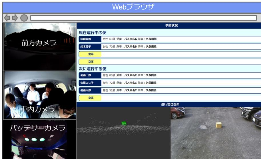
左：車内カメラによる、運転状況のモニタリング
