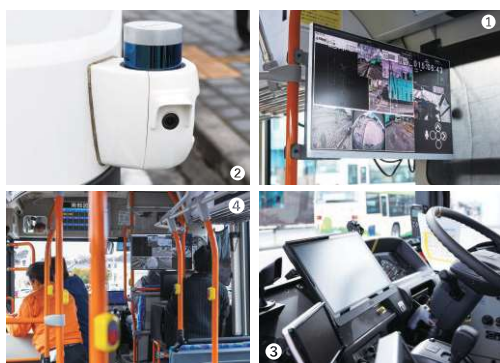
①センサーが感知した人や車をモニタリングできる。②カメラ付きLiDARセンサーで障害物や信号を探知。③運転席でもセンサーをチェック。④扉が開くタイミングなどを確認した試験走行。
